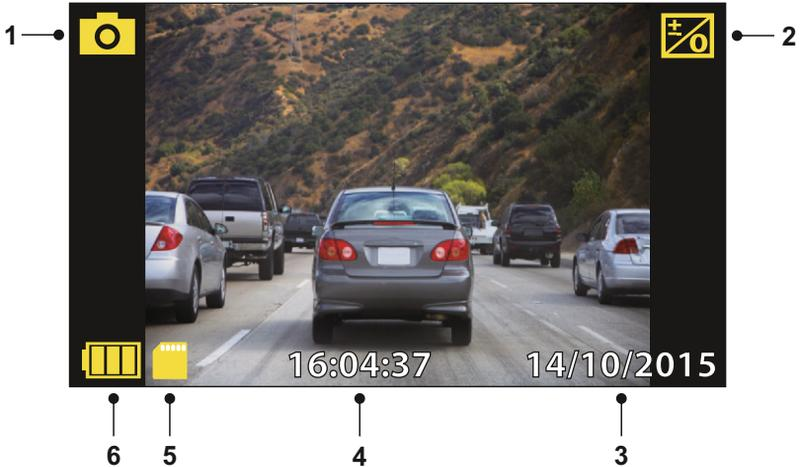
1. Modus: Anzeige, dass sich die iN-CAR CAM im Fotomodus befindet.
