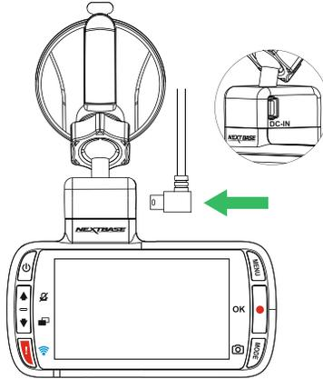
Schließen Sie das Fahrzeugkabel am 12-24 V DC Ausgang Ihres Fahrzeugs an.
