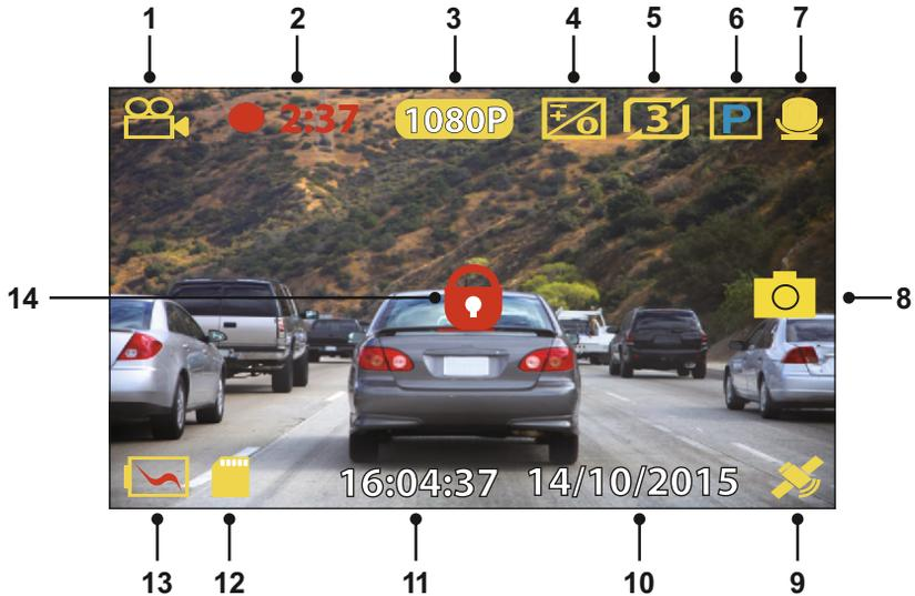
1. Modus: Anzeige, dass sich die iN-CAR CAM im Videomodus befindet.
