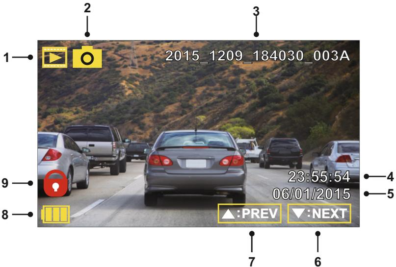
1. Modus: Anzeige, dass sich die iN-CAR CAM im Wiedergabemodus befindet.
