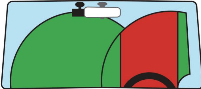
Montieren Sie die iN-CAR CAM NICHT direkt vor dem Fahrer, wie durch den roten Bereich in der obigen Abbildung illustriert.
